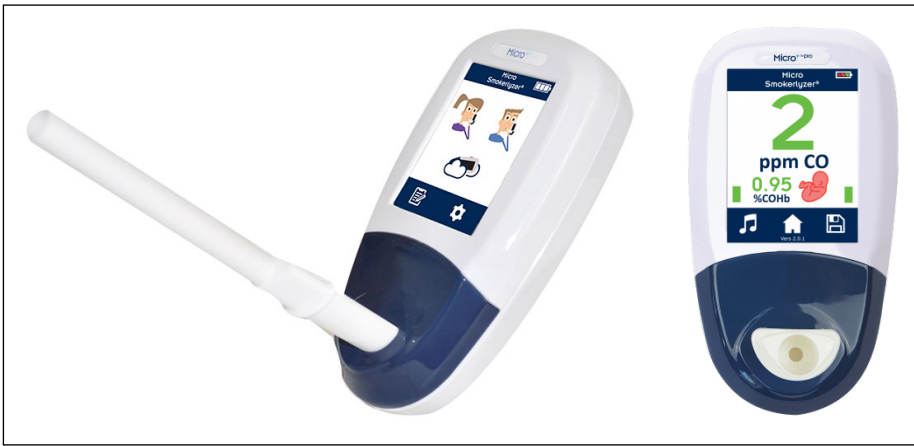
Fig. 3: Bedfont 'Micro' ademtester (zie kader).
