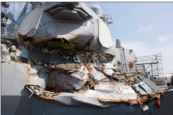
Afb. 13: Schade USS Fitzgerald na aanvaring met het vrachtschip ACX Crystal.
