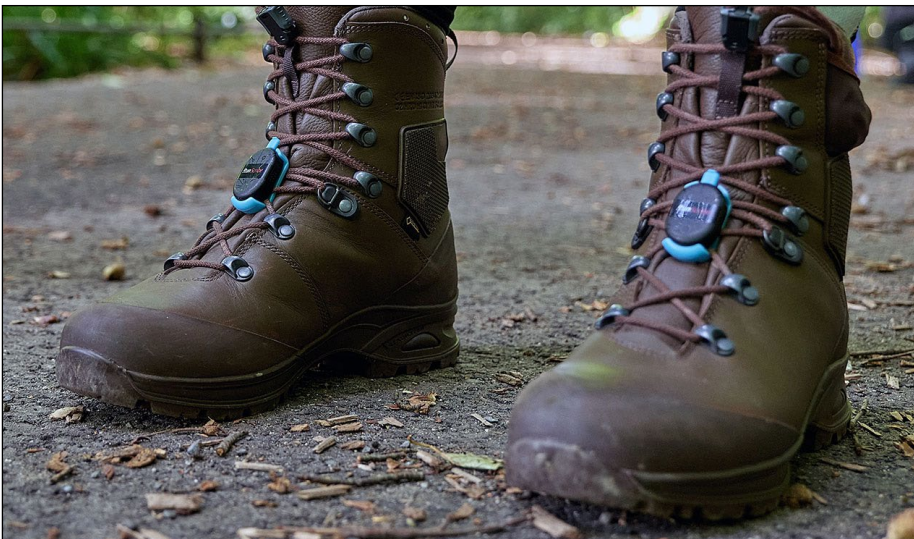
Afb. 2: De RunScribe sensor, vastgemaakt aan de veters van de laarzen, op de voetrug van een deelnemer. Foto: W.O. Zimmermann.
